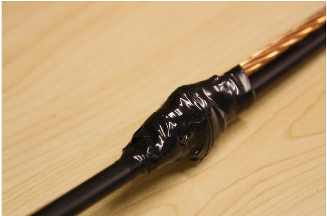
Suojaa liitoskohta jatkoksen mukana tulevalla vulkanoituvalla teipillä.
